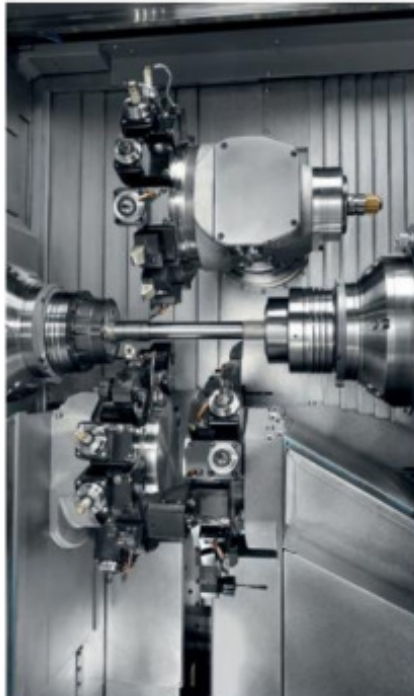
De hoofdspil en de drie revolvers (allen met Y-as) van de G200 kunnen gelijktijdig aan een product werken. Ook kunnen twee gereedschappen op de hoofdspil werken en het derde op de subspil.
